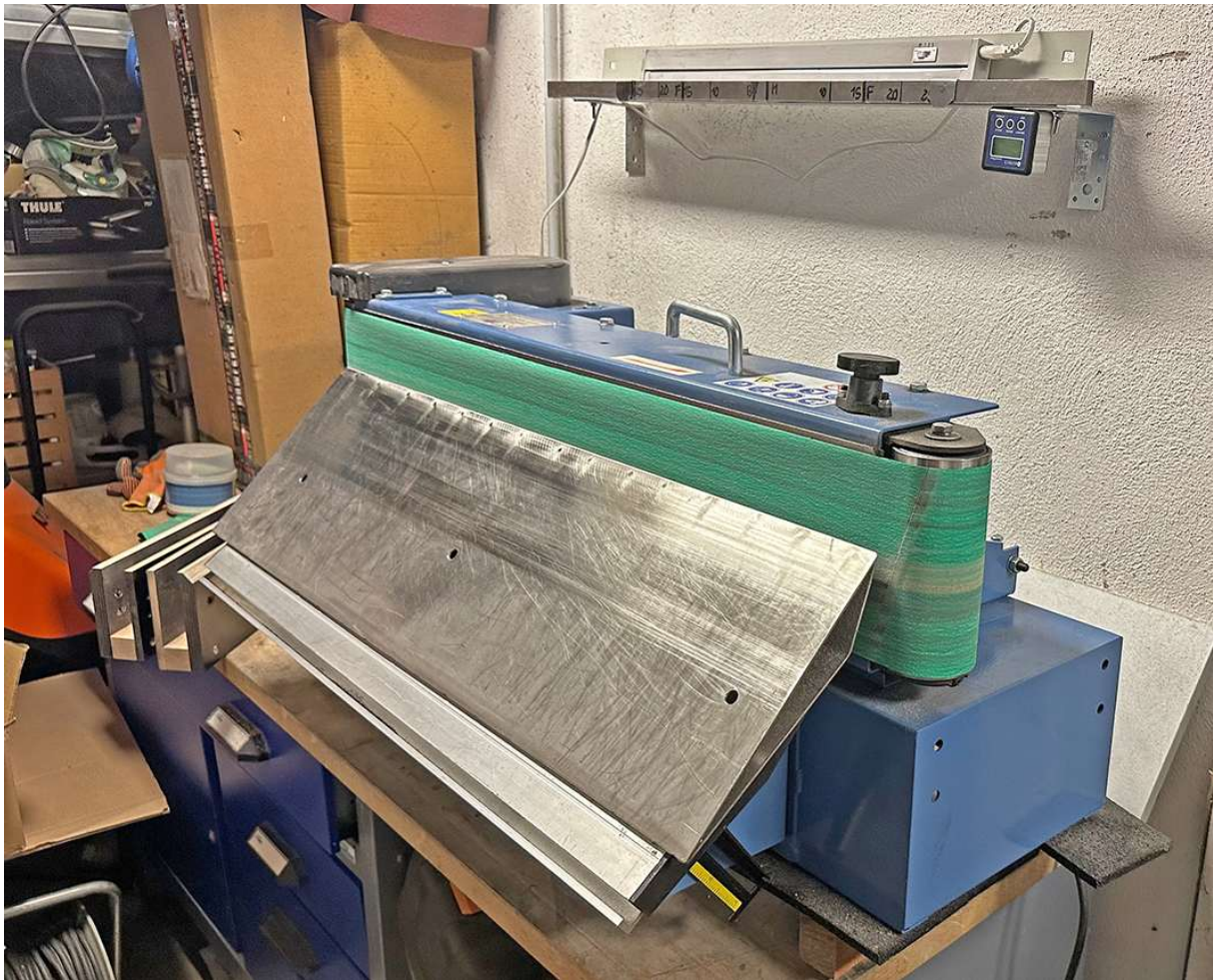
Modifizierte HBM 200 mit aufgeschraubtem 10°-Keil aus VA-Blech und Keramik-Schleifband. Oberhalb der Maschine ist meine „Kufensprungmessvorrichtung“, links von der Maschine die beiden „Brackets“ zur Aufnahme meiner Kufen zu sehen.
