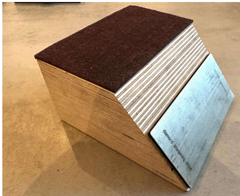
Schleiflehre für 95° Schliffwinkel mit Filz und Diamant-Schleifstein K400 (Filz kommt im Einsatz nach unten...)
