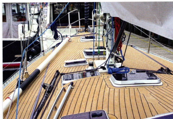
Das Deck bietet kaum Stolperfallen, Fallen und Reffleinen werden am Mast bedient. Viele Luken sorgen für Licht und Frischluft unter Deck, der Decksbelag aus Kunstteak stellte sich als sehr trittsicher heraus.
