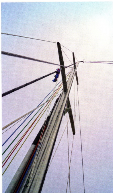
An Deck steht ein 9/10-Karbonrigg von Axxon, im Standard wird ein toppge-riggtter Aluminiummast geliefert.
