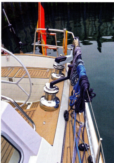
Die Breehorn ist im Heck deutlich schmaler als modernere Konstruktionen, dies kostet Platz im Cockpit.
