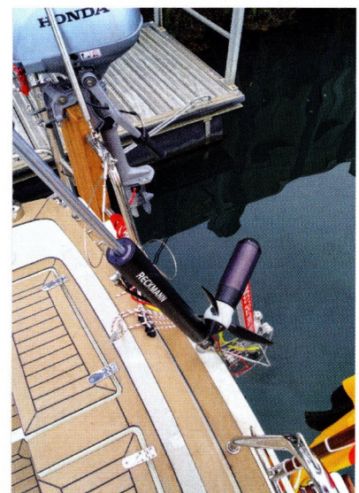
Am Heck hängt ein Hydrogenerator, weiterhin werden Wind und die Sonne zur Stromerzeugung genutzt.
