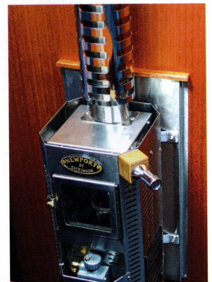
Der Dickinson-Öfen bietet bis zu 4,4 kW Heizleistung und schafft eine gemütliche Atmosphäre im Salon.
