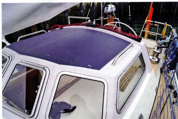
Der feste Dodger bietet nicht nur viel Schutz in schlechtem Wetter, er eignet sich auch trefflich zur Montage von Solarpaneelen. Diese sind trittfest ausgeführt und mit Antirutsch ausgestattet.
