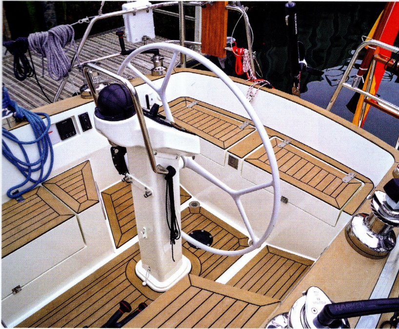
Das Komposit-Steuerrad ist größer als im Standard, so lässt es sich auch bestens vom Süll aus bedienen. Durch eine Schubstangenverbindung zum Quadranten vermittelt es gute Rückmeldung.
