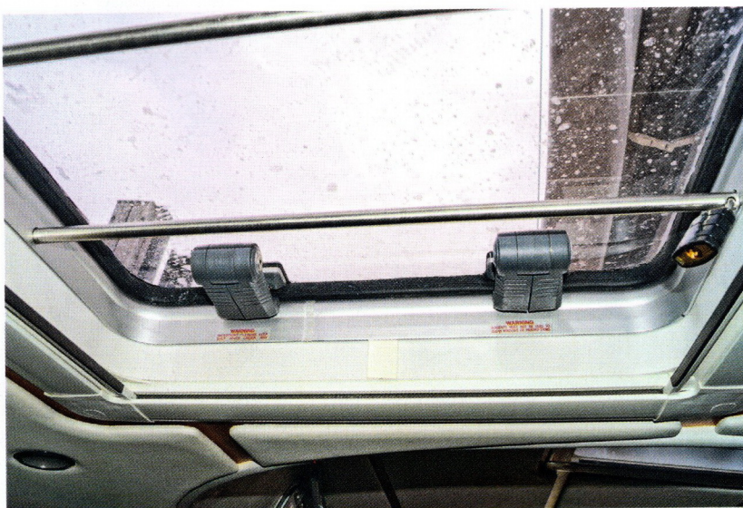
Die großen Luken können über Edelstahlstäbe zusätzlich als Einbruchschutz gesichert werden, sie sind mit Vorhängeschlössern versehen und abnehmbar, um auf See die Funktion als Fluchtluk zu erhalten.
