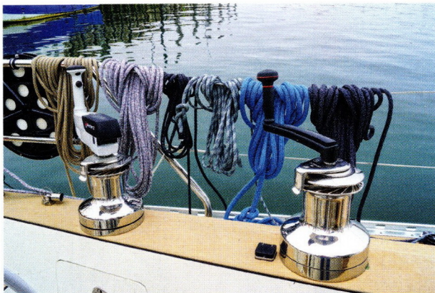
Die Winschenausstattung ist beeindruckend, aber teilweise unglücklich montiert. Achtern kollidiert die Kurbel mit dem Heckkorb, vorne gibt es E-Antrieb.
